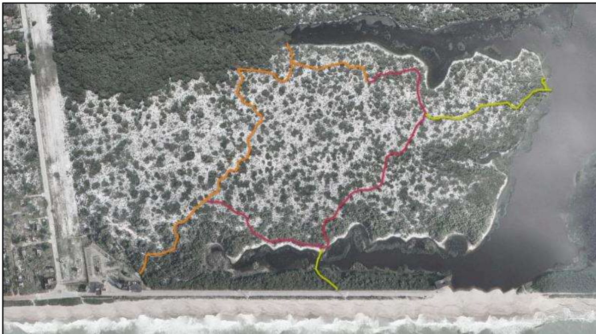
Figura 03: Plano indicando o faseamento da Etapa 1, subdividida em Etapa 1.1 (933m de extensão - cor laranja, objeto desta Especificação Técnica ), Etapa 1.2 (839m de extensão - cor magenta), Etapa 1.3 (328m de extensão - cor amarelo).
